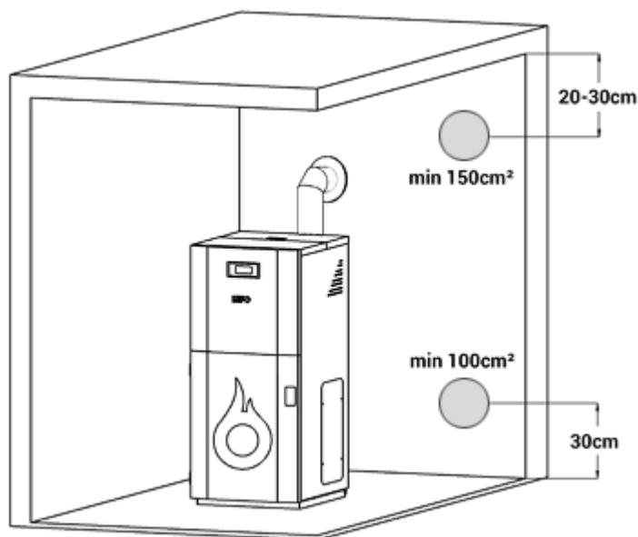
Ovi otvori moraju biti napravljeni tako da ni u jednom momentu ne može doći do njihovog začepljenja.
